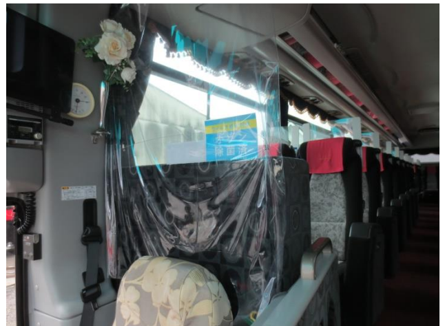
運転席と座席間に飛沫防止シートを設置
